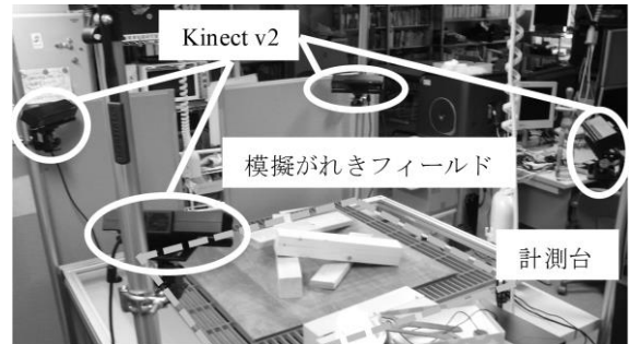
図1 模擬がれきフィールドの計測環境
